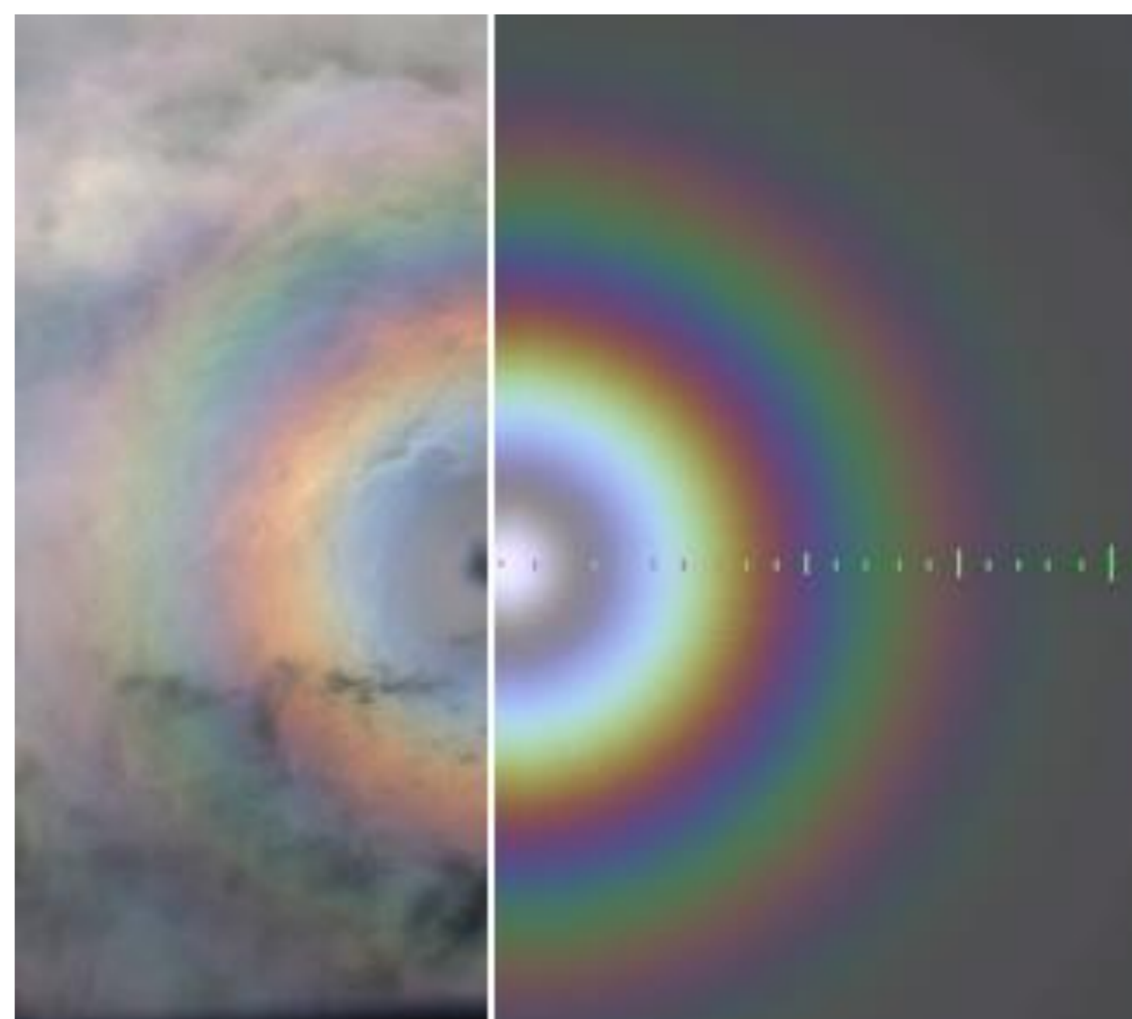
Figura 2: Calibração dos pixels da câmera utilizando o software Iris no modo Glória e comparação da imagem real com a simulada pelo Iris resultando em gotas com diâmetro de 12.5µm.
