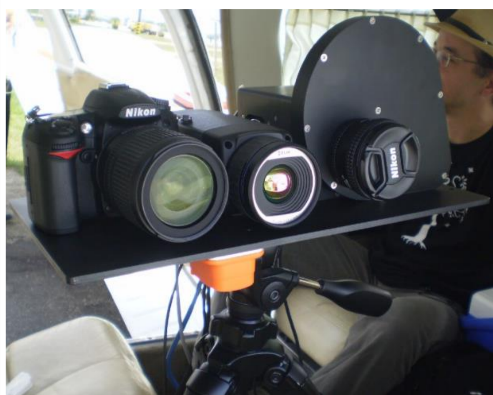
Figura 1: Câmeras no infravermelho e visível utilizadas na aquisição de dados e trajetória do avião sobre Rondônia.
